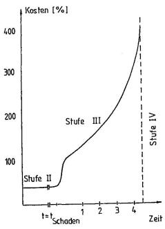
Bild 3 Entwicklung der Instandsetzungskosten für Beton in Abhängigkeit von der Zeit bei nicht erfolgter Instandsetzung
