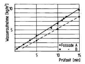
Bild 10: Wasseraufnahmen mit der Prüfplatte an hydrophobierten Sichtmauerwerksfassaden mit Haarrissen in den Fugen, Druckhöhe 100 mm
