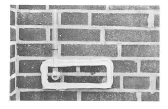
Bild 9: Spezielle Prüfplatte zur Messung der Wasseraufnahme von Fassaden
