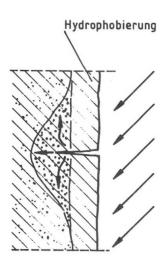
Feuchtigkeitsanreicherungen und Frostgefahr bei Wasserdurchtritt durch Fehlstellen.
