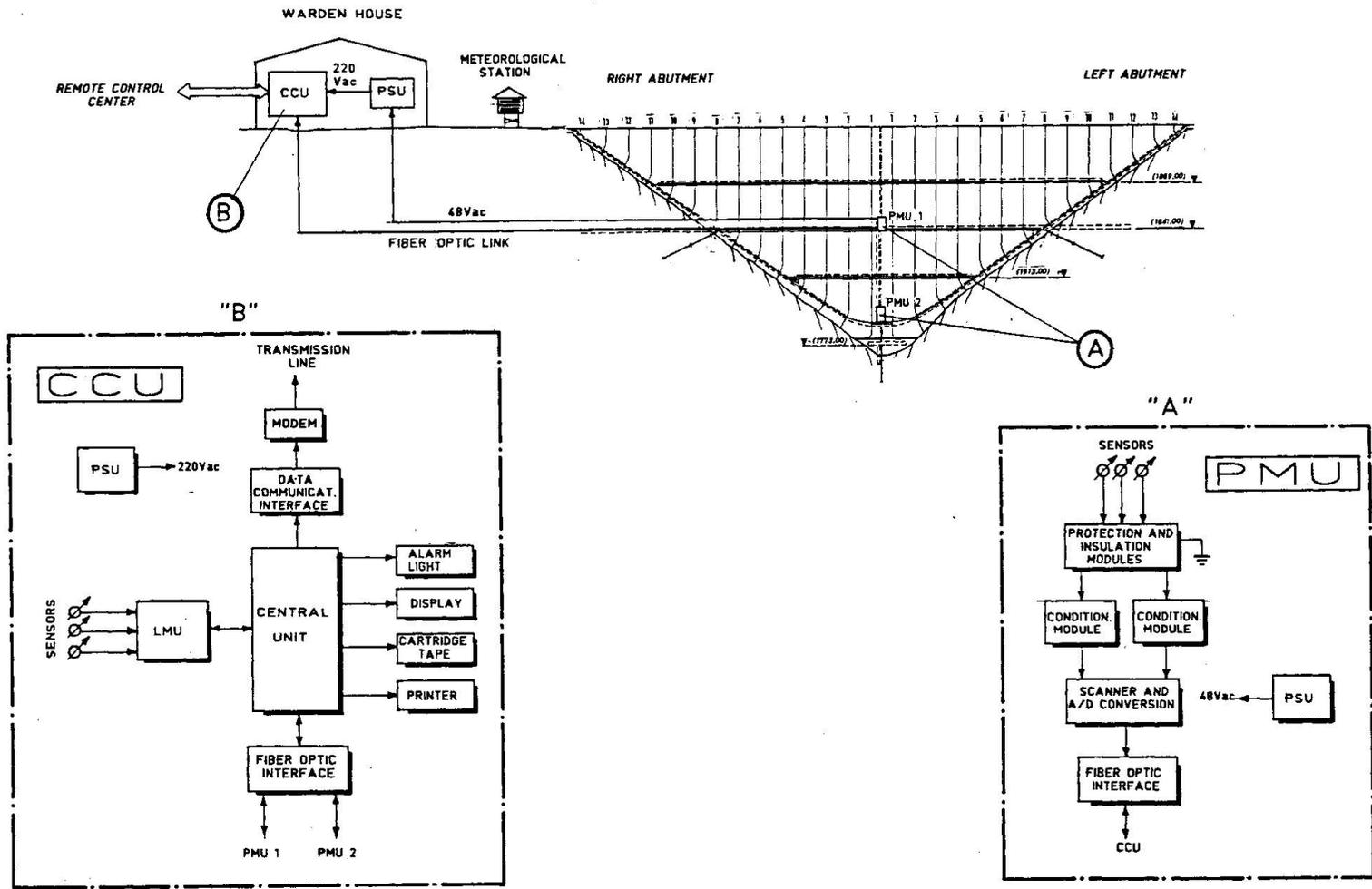
Fig. 5 - CANCANO DAM : MONITORING SYSTEM BLOCK DIAGRAM
