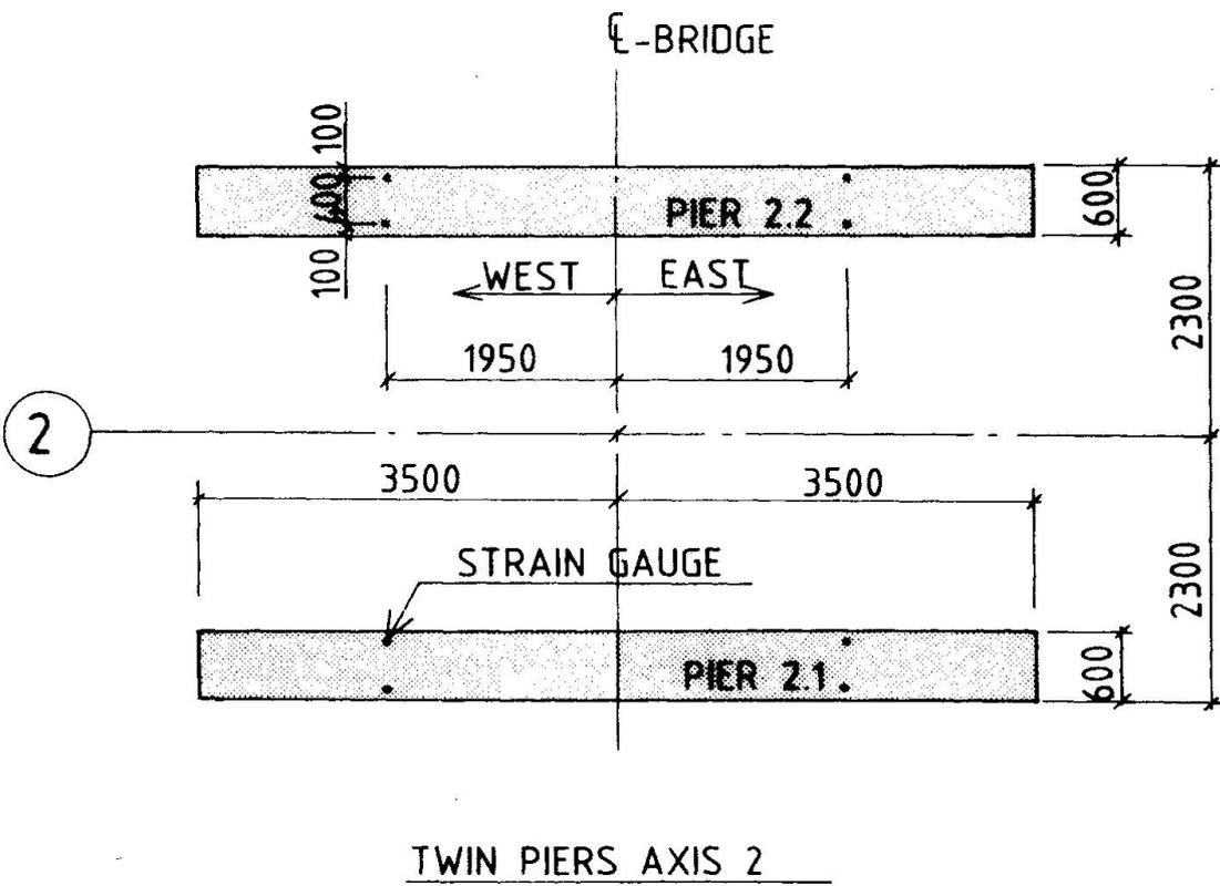
FIG 3. LOCATION OF STRAIN GAUGES
