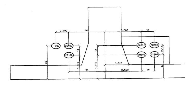
Figure 6 : Exemple de plan d'exécution pour déviateur exécuté au traceur Example of shop drawing for deviating block drawn by the plotter
