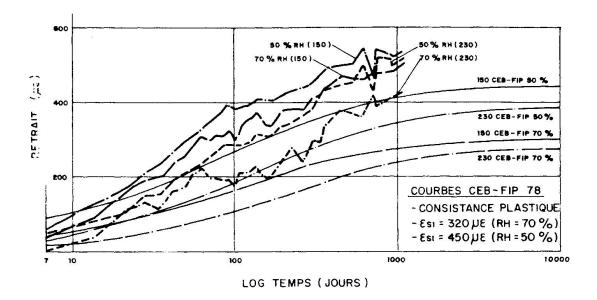
Fig. 2: Coefficients de retrait. Le facteur de correction adopté pour l'usage des courbes CEB / FIP 78 est d'environ 1.5
