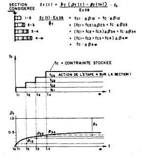
Fig. 3 : Plasticité différée. Example de détermination des coefficients pour une section et 4 étapes successives.
