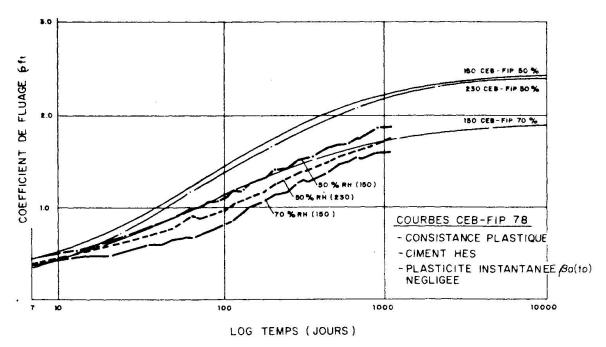
Fig. 1: Coefficients de fluage. Le facteur de correction adopté pour l'usage des courbes CEB / FIP 78 est d'env. 0.75.
