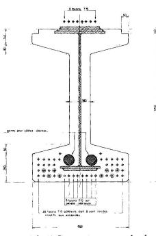
Fig.5 Coupe transversale de la poutre à mi-portée.
