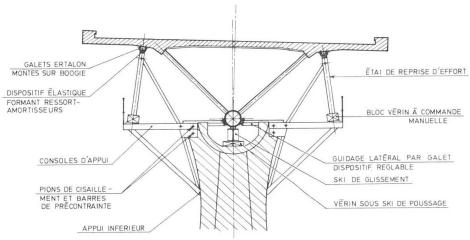
Fig. 6 : Stabilité sur les piles en cours de poussage
