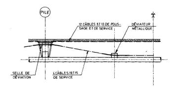
Fig. 7 : Coupe longitudinale type d'une demi-travée
