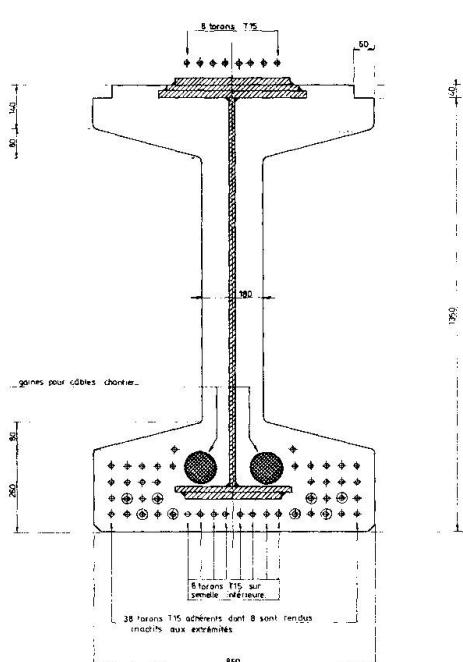
Fig.5 Coupe transversale de la poutre à mi-portée.
