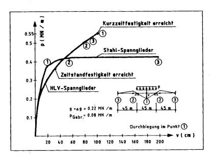
Bild 2 Last-Verformungs-Verhalten bei überlastung eines Innenfeldes eines Durchlaufträgers
