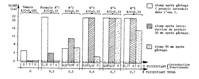
Figure 1 : Affaissement au cône d'Abrams (slump) d'un béton fluidifié en fonction du dosage en fluidifiant, de son mode d'introduction et du temps.
