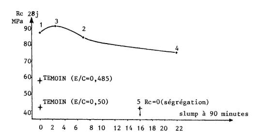
Du point de vue des résistances, la figure 2 montre que, par la seule réduction d'eau, obtenue avec l'introduction fractionnée du fluidifiant, on obtient des résistances à la compression à 28 j comprises entre 76 et 92 MPa. Les résistances les plus élevées se placent dans le cas où l'affaissement de 22 cm n'est maintenu que pendant 60 minutes (formule 1 et 3).
