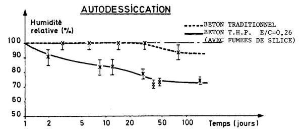
Figure 5 : Evolution de l'humidité interne avec le temps d'hydratation pour un béton traditionnel et pour un béton à très hautes performances avec fumées de silice (éprouvettes protégées de l'évaporation).
