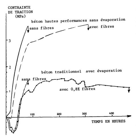
L'addition de fibres à la composition des bétons à très hautes performances permet de réduire ce phénomène de fissuration franche précoce, en favorisant la création d'une microfissuration répartie et en couturant les microfissures dès leurs apparitions.
