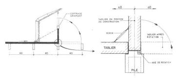
$\underline{\text{Fig. 5}}$  Construction d'un tablier à l'avancement par rotation dans un plan vertical
