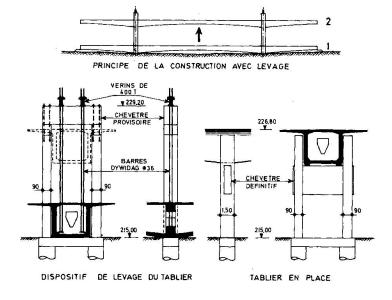
Fig. 3 Levage d'un tablier (projet Dragages et Travaux Publics)
