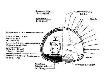
Fig. 4 Bergmännische Bauweise mit wu-Beton beim Burgbergtunnel
