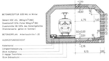
Fig. 3 Ausrüstungsschicht, Betonrezeptur und Betonierplan
