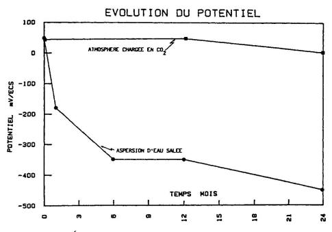
Fig. 3 Évolution du potentiel électrochimique des armatures
