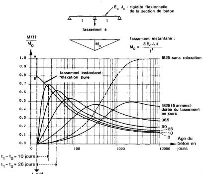
Les différentes courbes ont été calculées pour un tassement instantané qui correspond à la relaxation pure et pour des tassements plus ou moins lents, d'une durée de 10, 26, 90, 365 ou 1825 jours. L'évolution du tassement est admise affine au fluage du béton. Il est intéressant de constater que la valeur la plus faible de M(t) atteinte à travers le temps est celle correspondant à une durée de tassement de 365 jours avec max =  $\dot{\rm M}_{\rm O}$ 0.46.
