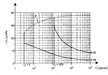
Pour un fluage  $\phi(t, t_0)$  donné, il est actuellement aisé de trouver par des méthodes numériques itératives la fonction relaxation  $r(t, t_0)$  en résolvant l'équation intégrale dite de Volterra (voir p.ex. [7, 15, 17, 18]). A titre d'exemple, nous montrons à la fig. 2 pour un certain béton situé dans un environnement de 70 % d'humidité relative et épais de 40 cm, deux fonctions relaxations  $r(t, t_0)$  en GPa pour  $t_0 = 3$  et 120 jours.
