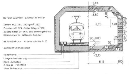
Fig. 3 Ausrüstungsschicht, Betonrezeptur und Betonierplan
