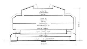
Fig. 6 Coupe vertical de usine de production de mégachips
