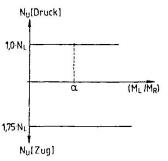
Fig. 3 Bemessungsschnittgrößen Mu, Nu in Abhängigkeit von ML/MR
