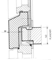
FIG. 2 COUPE VERTICALE ELEMENT DU FAÇADE
