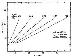
Fig. 4 Zusammenhang zwischen Bewehrungsgehalt µeff und Grenzdurchmesser max ds
