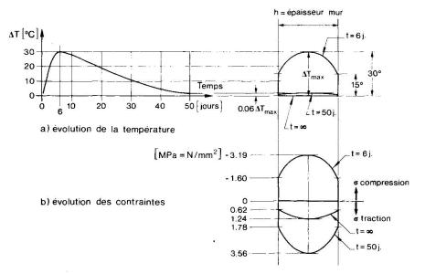
sons à nouveau un béton homogène. Par suite de la perte de chaleur sur les parements, nous supposerons que la température dans l'axe du toujours soit deux fois plus élevée que sur les parements (fig. 4). La température évolue en atteignant un maximum de 30 °C à l'axe au bout de 6 jours puis décroît avec le temps indiquée dans comme la figure.
