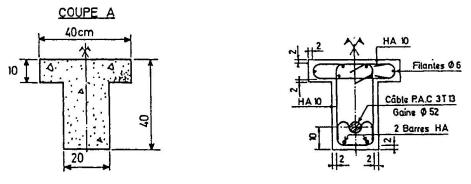
Fig. 1 - Poutres d'essai 1 et 2
