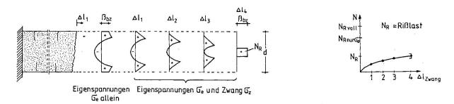
Fig. 2 Kombinierte Beanspruchung aus Eigenspannungen und Zwang
