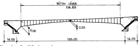
Fig. 1 - Profil du pont
