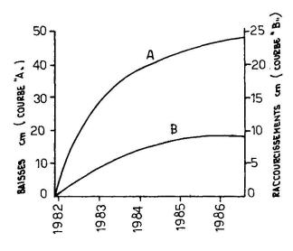
montre les diagrammes des baisses et des raccourcissements de la moitié du pont, déduits de les baisses par la transformation:
