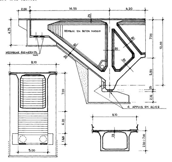
Fig. 6 - La culée avec sections
