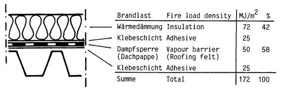
Bild 1 Brandlast im Dach
