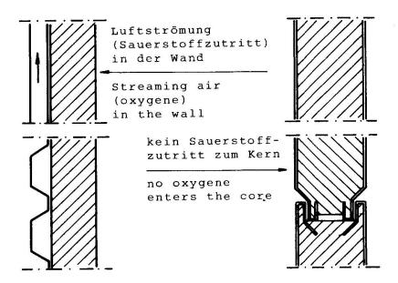
Bild 3 Sauerstoff-Zutritt in der Wandkonstruktion
