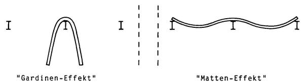
Bild 5 Versagensarten von Stahltrapezprofilen im Brand Fig. 5 Failure of corrugated sheets in a roof
