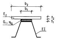
Bild 3 Balken mit Dämpfungsbelag mit unterbrochener Sperrschicht
