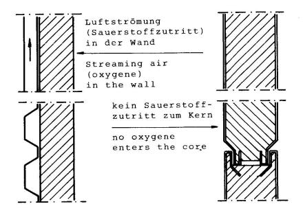
Bild 3 Sauerstoff-Zutritt in der Wandkonstruktion
