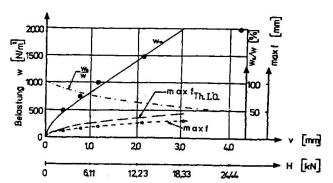
Bild 9. Theoretisch berechnete Kurven und einzelne Meßwerte (�;O) aus Bauteilversuchen
