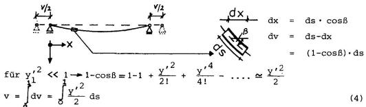
Bild 6. Geometrischer Zusammenhang zwischen Durchbiegung und Auflagerverschiebung
