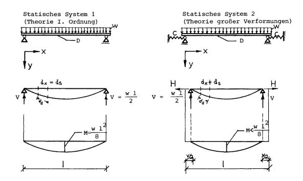
Bild 1. Einachsig gespannte Platte unter Windlast w
