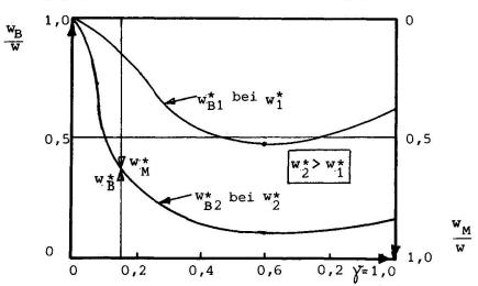
Bild 10. Lastabtragungsanteile aus Membran- und Biegetragwirkung (qualitativer Verlauf) in Abhängigkeit von Plattenseitenverhältnis  $\gamma$  und der Lasthöhe w\* (Die Summe aus w\* und w\* gibt immer 1)
