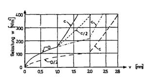
Bild 8. Last-Auflagerverschiebungskurven für verschiedene v, c und D
