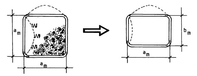
Figure 3 - Profil rectangulaire équivalent.
