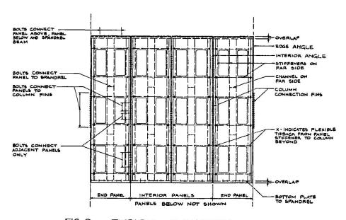
FIG. 9 TYPICAL ELEVATION
