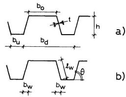
Figure 1: a) relevant parameters
