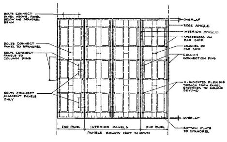
FIG. 9 TYPICAL ELEVATION
