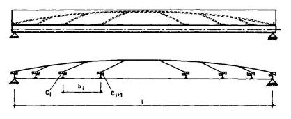
Fig. 2 Berechnungsmodell Einfelddecke
