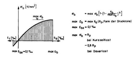
Fig. 4 Spannungsverteilung über Betonbiegedruck- und -zugzone
