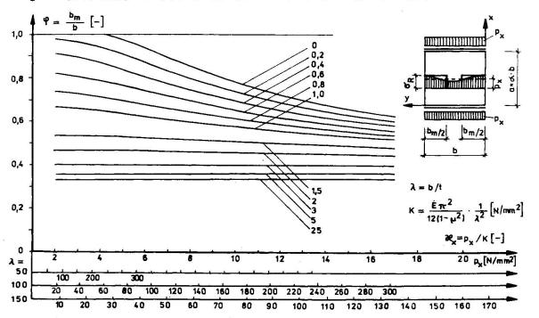
Fig. 5 Mitwirkende Breite des Druckflansches im Verbundzustand
