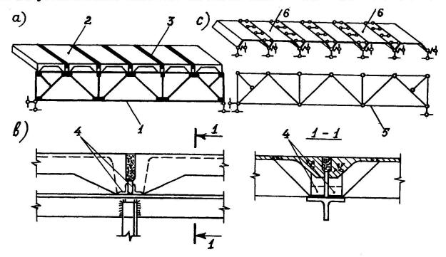
Fig. 3. Verbunddecke: a - Konstruktion; b - Platte-Binder-Verbindungsknoten; c - Berechnungsschema; 1 - Binder; 2 - Platte; 3 - Vergussbeton; 4 - Einlegeteile; 5, 6 - Randsuperelemente "Binder" und "Platte".
