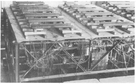
Fig. 4. Versuche mit einem Stahlbetonverbundfragment
