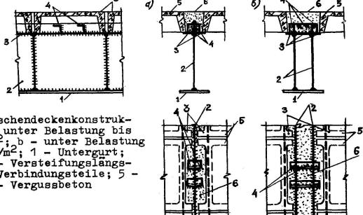
Fig. 5. Zwischendeckenkonstruktionen: a - unter Belastung bis zu 100 kN/m<sup>2</sup>; b - unter Belastung über 100 kN/m<sup>2</sup>; 1 - Untergurt; 2- Steg; 3 - Versteifungslängs-rippe; 4 - Verbindungsteile; 5 -Platten: 6 - Vergussbeton
