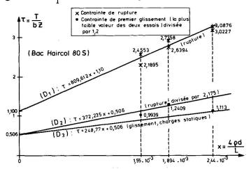
Fig. 4 - Détermination semi-empirique de la limite d'adhérence
