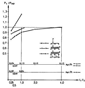
Bild 2: Traglasten für unterschiedliche Werte  $\ell_1/\ell_2$  und  $x_{pl}/h$
