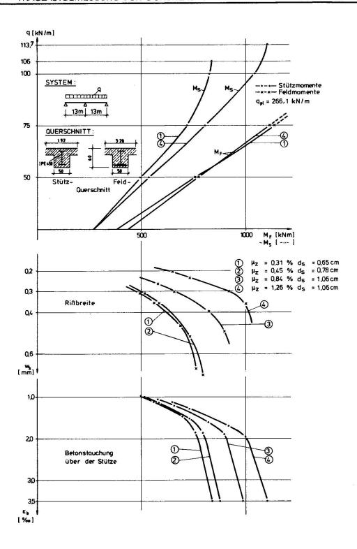
Bild 8: Bemessungdiagramm für einbetonierten Träger
