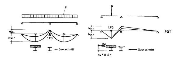
Bild 5: Anforderungen an die Querschnitte bei der Fließgelenktheorie
