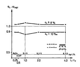
Bild 4: Traglasten für unterschiedliche Werte  $\ell_1/\ell_2$ und  $x_{pl}/h$
