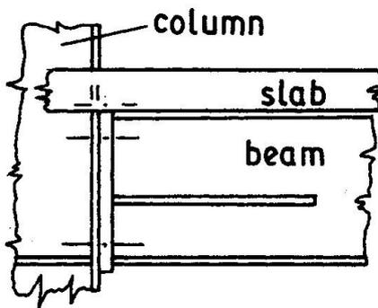
**Fig. 1** Longitudinal stiffener
