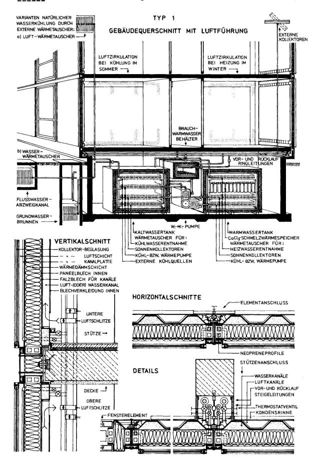
sein, weil dort die Wärme hauptsächlich der Außenluft entzogen werden muß und diese mit dem Wind unmittelbaren Zugang zu den Absorberflächen des Kollektors haben muß. Dieser Wärmeentzug ist möglich, weil der Kaltwassertank mit der niedrigen Temperatur der Wärmepumpen-Verdampferflüssigkeit unter der Außenlufttemperatur gehalten werden kann. Bei sehr niedrigen Außentemperaturen muß allerdings mit Strom oder Gas bivalent zugeheizt werden.
