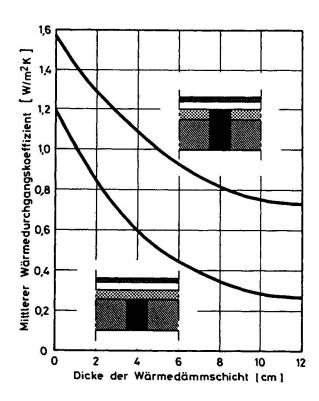
Bild 7 Mittlerer Wärmedurchgangskoeffizient mit am Anschluß unterbrochener und durchgezogener Wärmedämmschicht, in Abhängigkeit von der Dämmschichtdicke.
