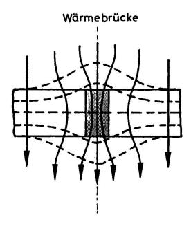
Bild 6 Schematische Darstellung einer Wärmebrücke.
