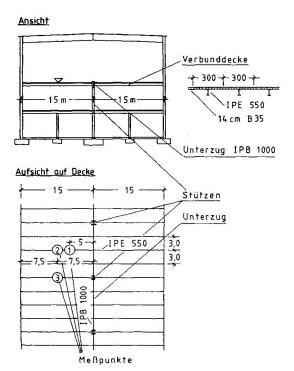
Bild 8: Abmessungen der Deckenkonstruktion einer Ausstellungshalle in Berlin /8/
