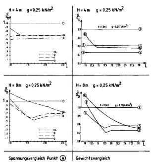
Bild 3: Auswirkung unterschiedlicher nationaler Lastnormen (B, D, F, NL) auf die Spannungen O/O und Gewichte G/G bezogen auf deutsche Vorschriften bei Hallenrahmen /3/.
