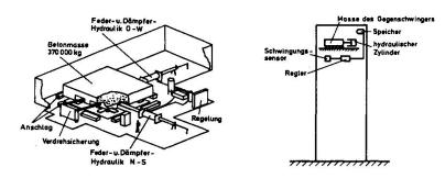
Bild 10: Ausrüstung eines Hochhauses mit passiven oder aktiven Schwingungsdämpfern /9/, /10/
