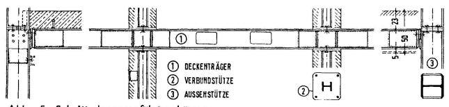
Abb. 5 Schnitt der ausgeführten Lösung
