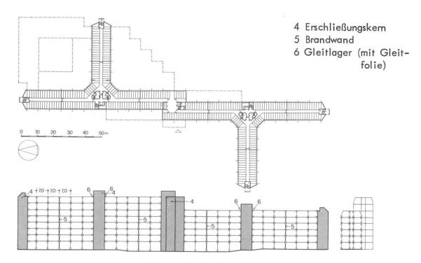
Abb. 2 Grundriß Normalgeschoß, statisches System im Längs-und Querschnitt
