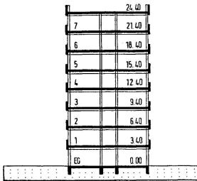
Abb. 8 Schnitt durch einen Verwaltungsbau mit reduzierter Geschoßhöhe von 3 m
