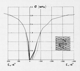
Fig. 11  $\sigma$  -  $\epsilon$  diagram.
