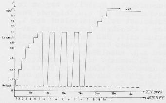
Bild 1 Zweckmäßige Belastungsfolge einer Probebelastung
