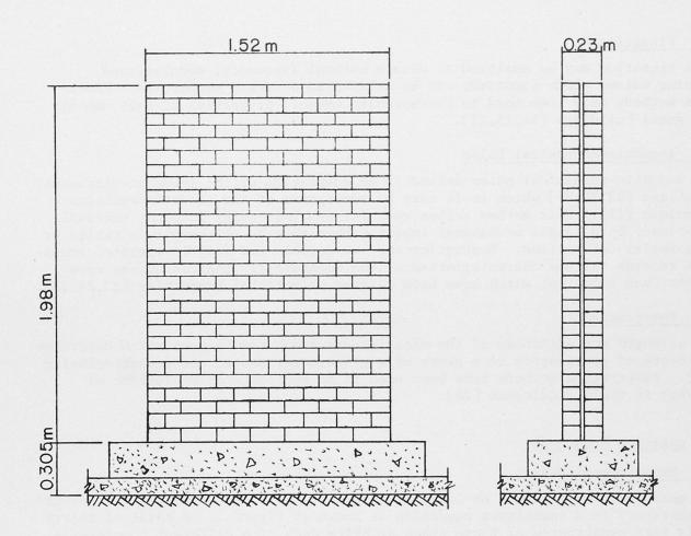
FIGURE I - BRICK MASONRY WALL SPECIMEN
