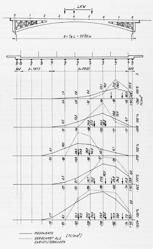
Abb. 2. Spannungen auf dem unteren Gurtblech der Bogenträgern in dem Viertelquerschnitt
