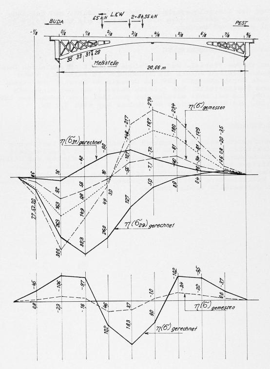
Abb. 4. Gerechnete und gemessene Lastenzug-Einflusslinie der Randfaser-Spannungen (N/mm²) in dem Viertelund Mittelquerschnitt der Bogenbrücke
