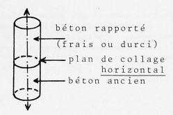
Figure 1 : Essai de traction directe sur cylindre scié et reconstitue suivant un plan médian perpendiculaire à la direction des génératrices.
