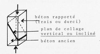
Figure 2 : Essai de compression sur prisme scié et recollé suivant un plan oblique faisant un angle de 30° avec l'axe longitudinal de l'éprouvette.
