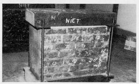
Les résultats présentés sont obtenus sur la maçonnerie d'un bâtiment érigé au 17ème siècle près de Hasselt. Quatre murs ont été préparés pour les essais (Fig. 4).
