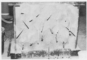
Fig. 2 Tubes d'injection, fixés par un ciment rapide.
