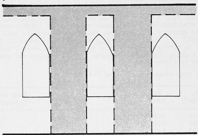
Fig. 3 Création d'une ossature par injection
