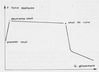
Des capteurs de déplacements, montés sur l'éprouvette permettent de tracer, en continu, les courbes représentatives du glissement de l'extrémité non chargée de la barre, par rapport au béton.
