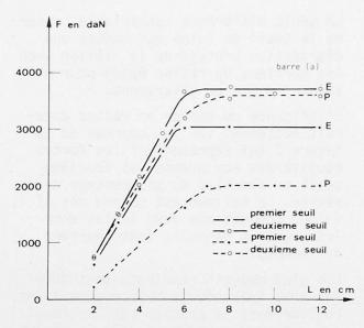
Fig. 3 Variations des résistances aux ler et 2ème seuils de glissement en fonction de la longueur d'enrobage
