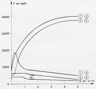
Fig. 6 Mortier de résine polyester. Rôle des facteurs d'adhérence
