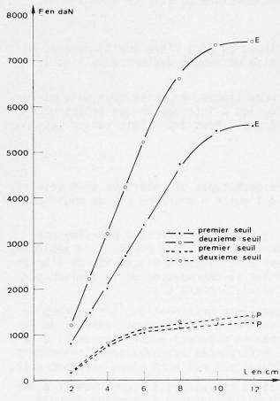
Fig. 4 Variations des résistances aux ler et 2ème seuils de glissement en fonction de la longueur d'enrobage
