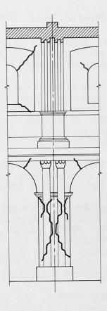
Fig. 6 Fissures typiques provoquées par le séisme de 1976.
