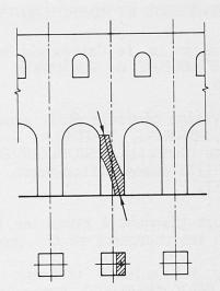
Fig. 15 Principes adoptés pour le renfort et schéma de transmission des charges.
