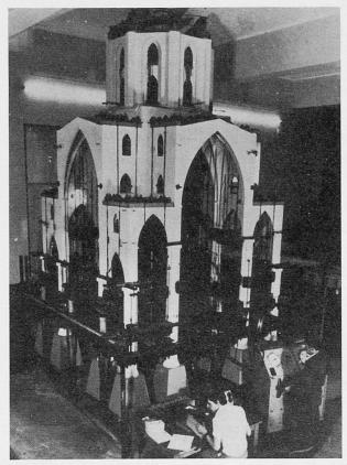
Fig.3 Le modèle élastique, à échelle 1:15, Fig. 2 vue d'ensemble, prêt pour les essais
