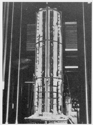
Modèle de hauteur réduite (3 m) après la rupture. On voit l'ap pareillage de mesure.
