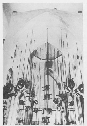
Fig. 5 Dispositif de charge (au poids propre) du modèle élastique
