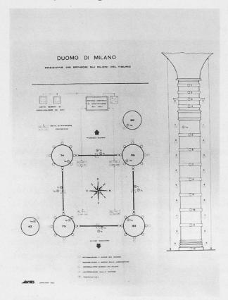
$\underline{\text{Fig. 11}}$  Plan des instruments électriques  $\cdot \underline{\text{Fig. 12}}$  Centrale automatique pour le appliqués à une des colonnes
