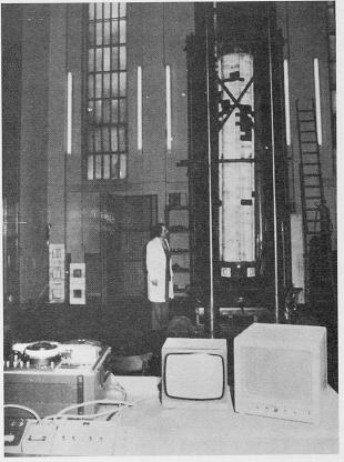
$\frac{\text{Fig. 8}}{\text{la presse de 2.000 t}}$  Modèle d' une des colonnes sous
