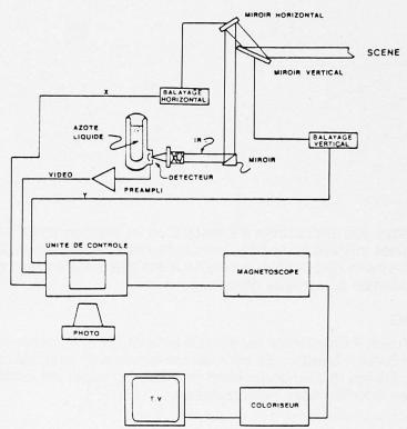
Fig. 1 Schéma de fonctionnement
