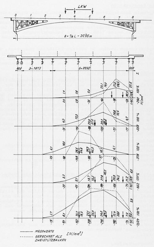
Abb. 2. Spannungen auf dem unteren Gurtblech der Bogenträgern in dem Viertelquerschnitt
