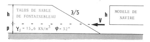
FIGURE 2 : Talus de protection contre les chocs des navires.
