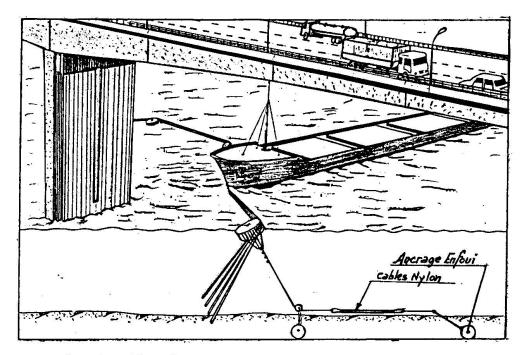
Fig. 3 Protection de piles de ponts.
