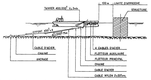
Fig. 2 Ecran de protection (élévation).
