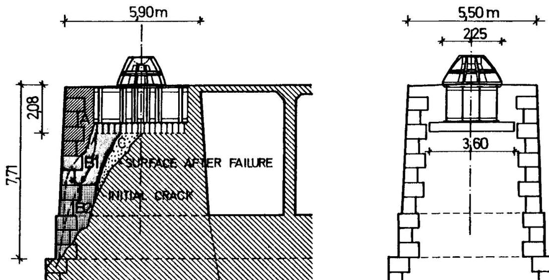
FIG. 4 : PIER XVIIa CRACK FORMATION AT FAILURE
