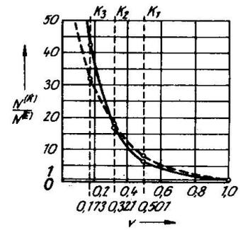
**Bild 5** Einfluß der Kollektivform auf die mittlere relative Lebensdauer  $\frac{N^{(K)}}{N^{(E)}}$  im Zeitfestigkeitsbereich ( $N < 2 \cdot 10^6$ )
