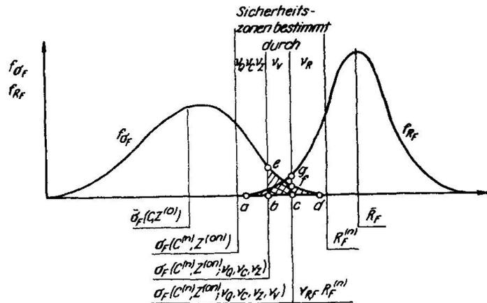
**Bild 3** Rechenfaktoren  $\gamma_i$  zur Berücksichtigung von Unsicherheiten in den Einflußgrößen
