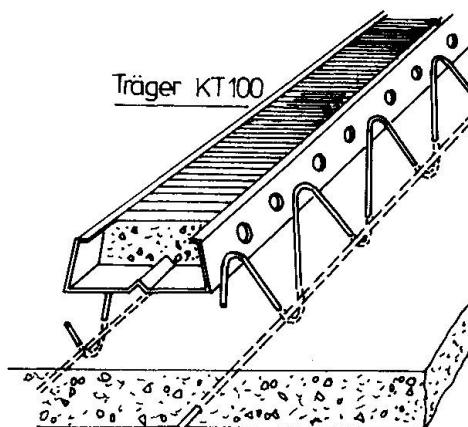
Bild 6: MONTAQUICK - montagesteife Fertigplatte
