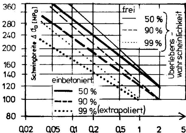
Bild 4: Ergebnisse im einbetonierten Zustand. 50% Überlebenswahrscheinlichkeit
