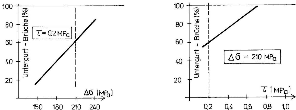
Bild 7: Anteil der Untergurtbrüche an den Untergurtknotenpunkten im Schubbereich
