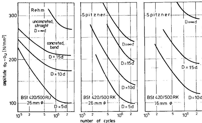
Das ungünstigere Verhalten gekrümmter Stäbe gegenüber geraden wird zurückgeführt auf Kaltverformung, Eigenspannungen und Zusatzspannungen infolge Krümmungsaufweitung. Beim Biegen von Rippenstählen kommt es an den Übergängen Stabkern/Rippen zu örtlich hohen plastischen Verformungen. Dadurch wird die Verformungsfähigkeit örtlich stark erniedrigt (insbesondere nach Alterung) und die Kerbwirkung der Rippen erhöht.
