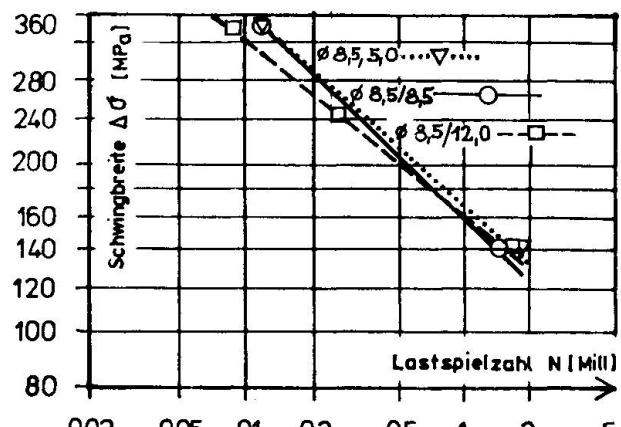
Bild 1: Einfluß der Stabkombination auf die Zeitschwingfestigkeit von geschweißten Betonstahlmatten. 50% Überlebenswahrscheinlichkeit; Schweißeinstellung normal
