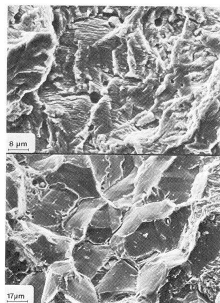
Das Schweißnahtgefüge kann in Ausnahmefällen ebenfalls das Ergebnis beeinflussen (metallurgische Kerbwirkung). Ein ungünstigeres Verhalten wurde bei kleineren Stabdurchmessern kaltverformter Stähle infolge Entfestigung und bei warmgewalzten Stählen dickerer Abmessung und erhöhtem Kohlenstoffgehalt infolge Aufhärtung festgestellt. Im letzteren Fall unterscheidet sich die interkristalline Bruchstruktur im Aufhärtungsbereich am Bruchausgang deutlich von der übrigen Bruchstruktur (Fig. 15).
