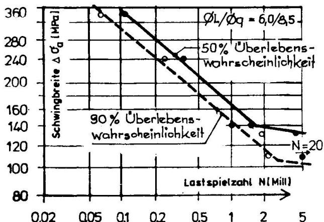
Bild 2: Normierte Wöhlerlinie für geschweißte Betonstahlmatten am Beispiel der Stabkombination 6,0/8,5mm
