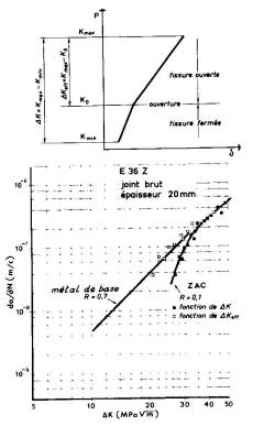
Figure 10 Vitesse de fissuration en fonction de  $\Delta K_{\mbox{eff}}$
