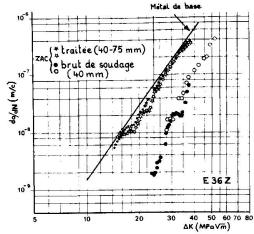
Figure 9 Effet d'un traitement de détensionnement
