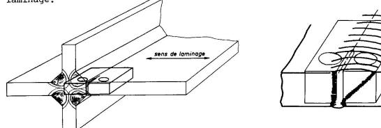
Figure 1 Prélèvement des éprouvettes dans Figure 2 Prélèvement des éprouvettes les joints soudés en croix
