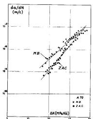
Evolution de da/dN = F (  $\Delta$ K) Figure 6 Evolution de da/dN = f (  $\Delta$ K) Figure 5 Acier E355 Acier A70
