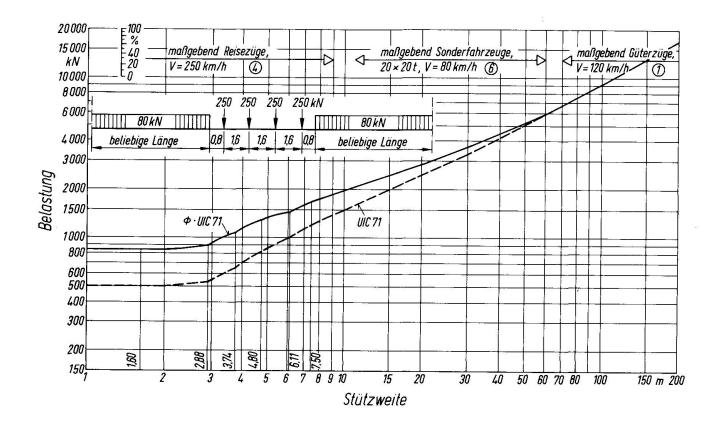
Bild 2: Belastungsbild UIC 71 und Biegemomente in Balken auf 2 Stützen in Abhängigkeit von der Stützweite.
