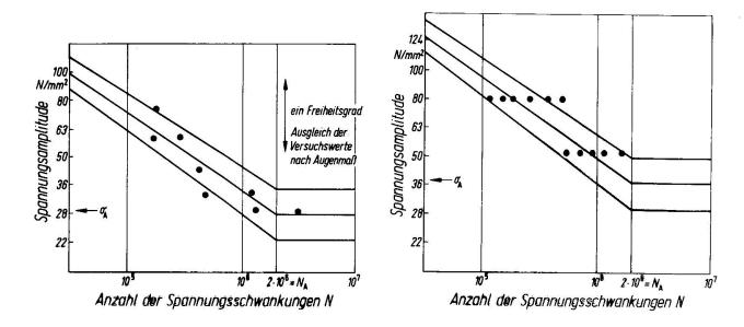
Bild 4: Auswertung von Versuchsergebnissen mit Hilfe der normierten Wöhlerlinie für Schweißverbindungen aus Baustahl.
