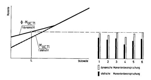
Bild 3: Verfahren zur Ermittlung der dynamischen Momentenbeanspruchung.
