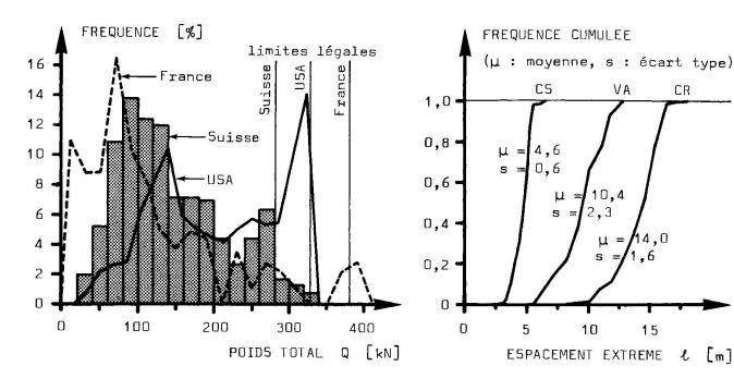
FIGURE 2: Histogramme des poids totaux de camions pesés en Suisse et comparaison avec deux autres trafics.
