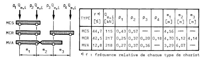
FIGURE 4 : Schéma et caractéristiques des trois chariots types composant le modèle de charge du trafic.
