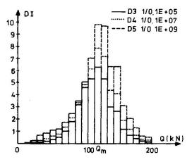
Figure 4 : Dommage en fatigue en fonction du poids des essieux à Caronte
